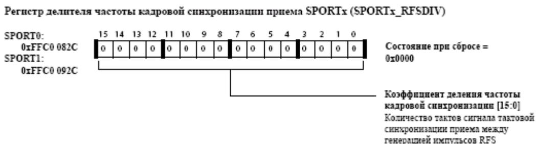
Рис. 12-16. Регистр делителя частоты кадровой синхронизации приёма SPORT<sub>x</sub>
