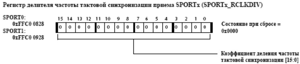
Рис. 12-14. Регистр делителя частоты тактовой синхронизации приёма SPORT<sub>x</sub>
