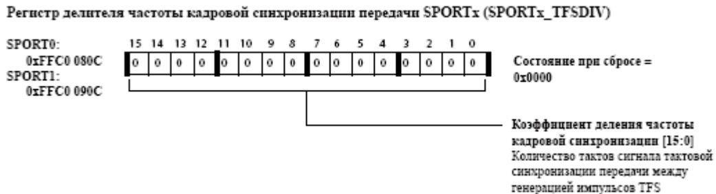
Рис. 12-15. Регистр делителя частоты кадровой синхронизации передачи SPORT<sub>x</sub>
