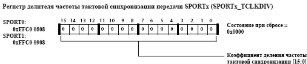
Рис. 12-13. Регистр делителя частоты тактовой синхронизации передачи `SPORTx`
